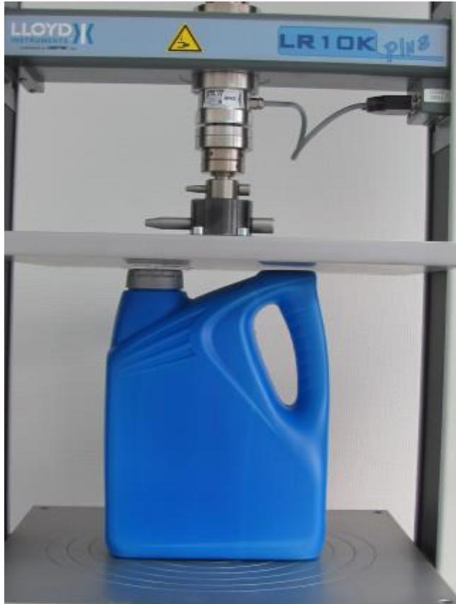
После укупорки и сверления отверстия 3-4мм в крышке
