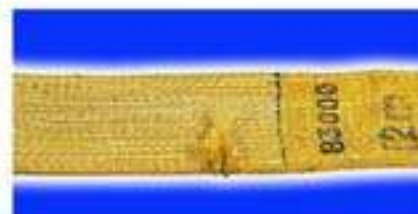
Повреждение главного шва
