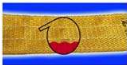
Повреждение в результате воздействия кислоты/щелочи
